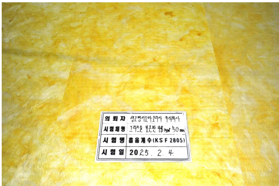
[사진 2] 단위 시료간 접합면 모습
